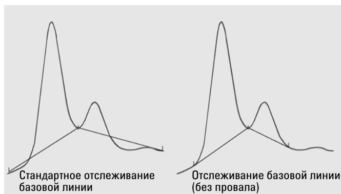
Рисунок 9 Стандартное отслеживание базовой линии и отслеживание базовой линии без провала.
